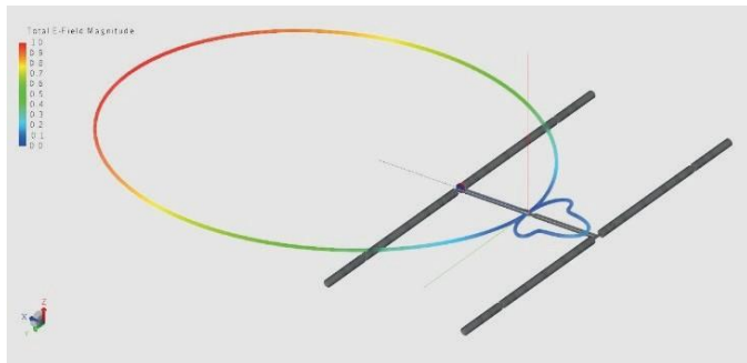
図10：アンテナ2：指向性ダイポールアンテナの代表的な水平特性、遠方界として計算。
