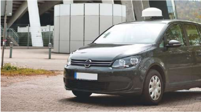
図3：マグネット式取付治具：車両屋根への取り付けが容易
