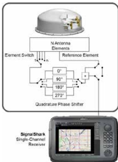
図5：方向探査原理
